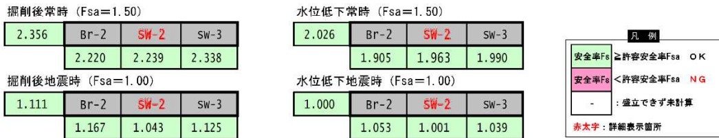
図2-5 調整池周辺の掘削法面の安全率
