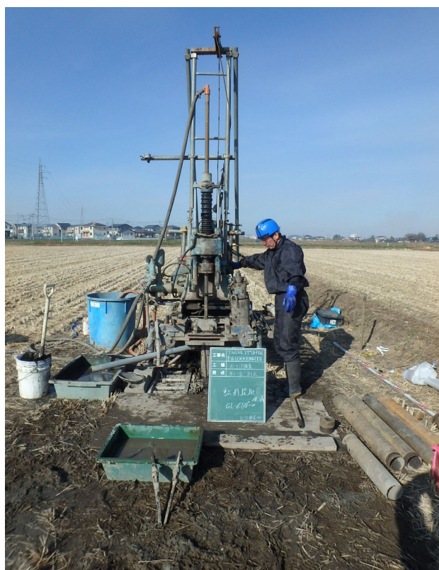
シンウォールサンプリング状況 (深度6.8m)
