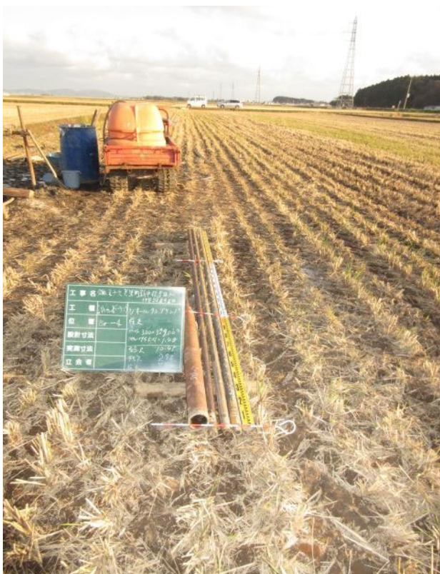
シンウォールサンプリング状況 (深度7.5m)
