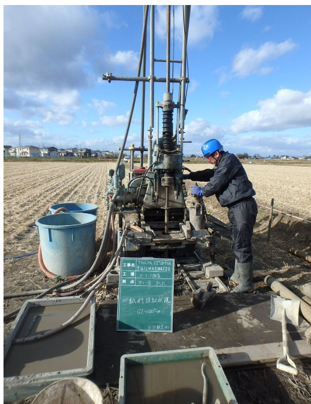
シンウォールサンプリング状況（深度1.0m）
