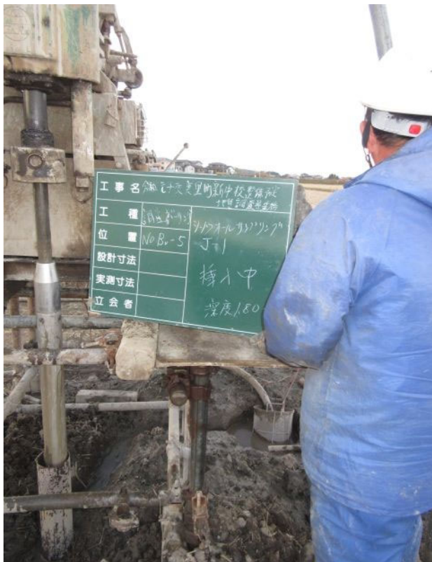
シンウォールサンプリング状況 (深度1.8m)
