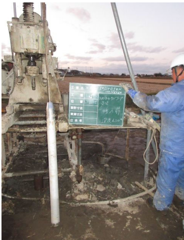
シンウォールサンプリング状況 (深度1.8m)
