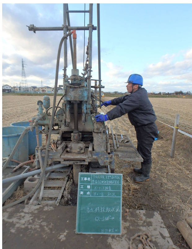
シンウォールサンプリング状況（深度1.0m）
