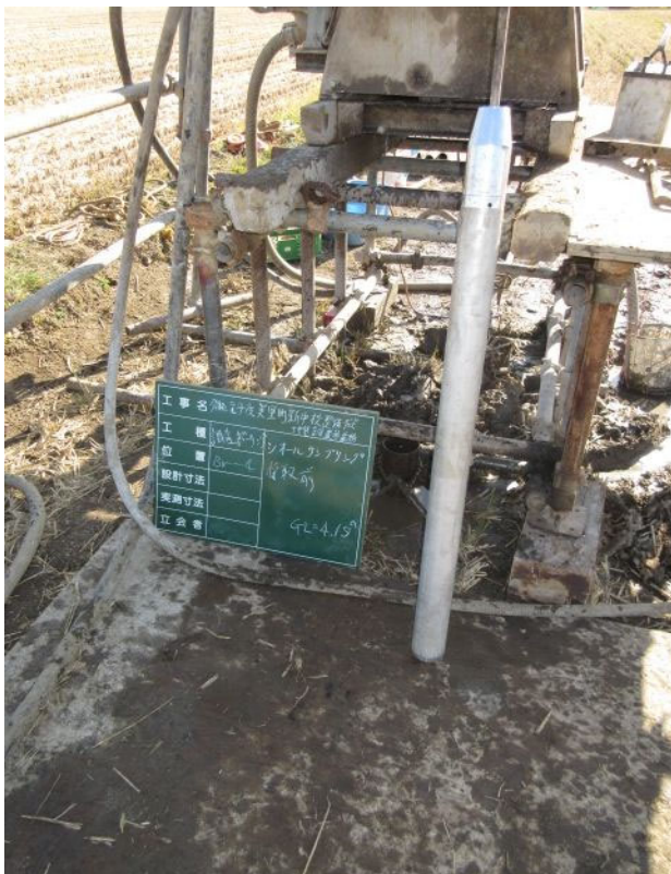
シンワールサンプリング状況（深度2.0m）
