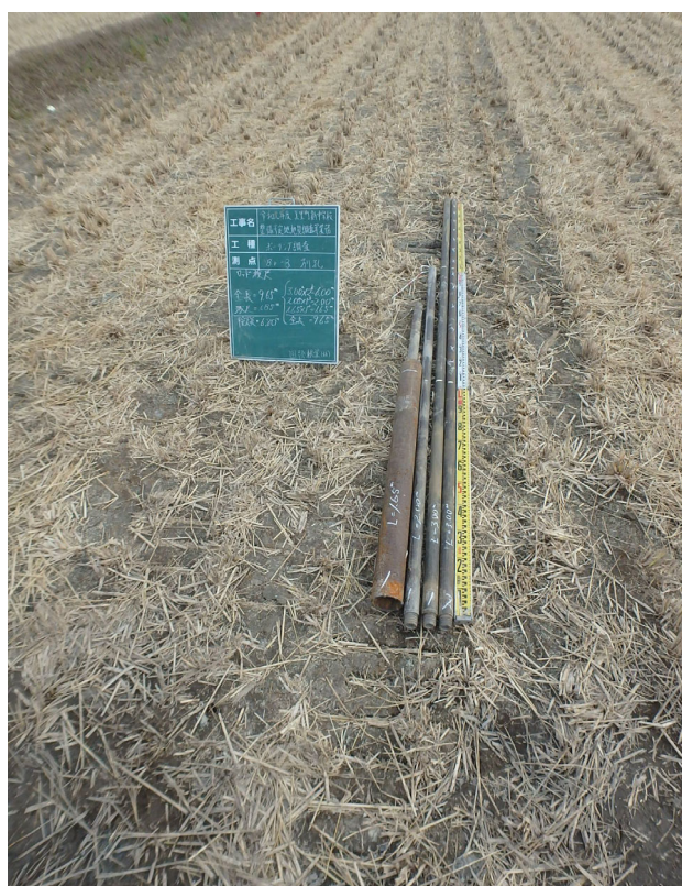
シンウォールサンプリング状況 (深度6.8m)
