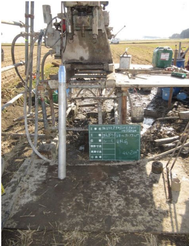
シンワールサンプリング状況（深度2.0m）
