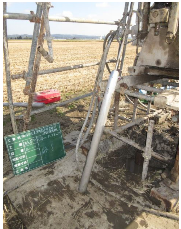
サンプリング試料（深度2.0m）
