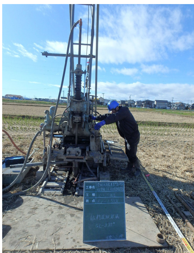
シンウォールサンプリング状況（深度2.0m）
