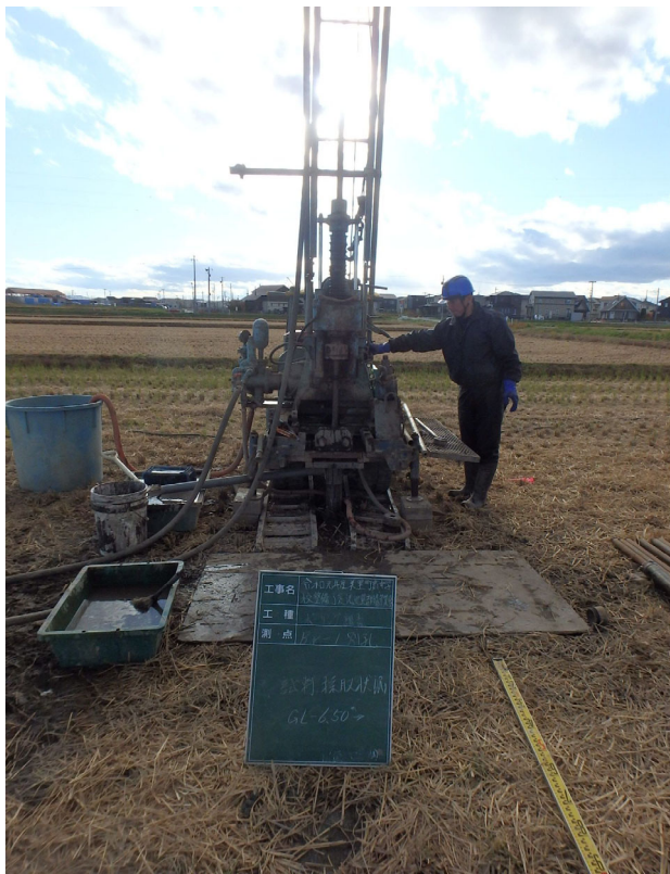
シンウォールサンプリング状況 (深度6.5m)
