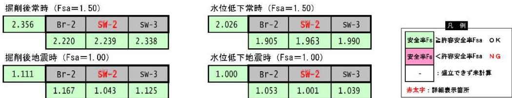
図2-5 調整池周辺の掘削法面の安全率
