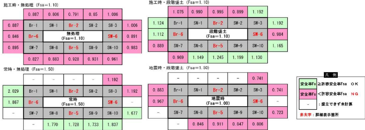
図2-3 宅地の安全率（施工時、常時、地震時）
